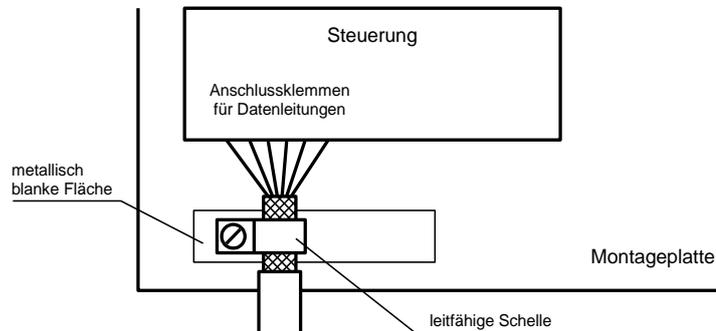
Die Leitungsschirme sind an beiden Leitungsenden anzuschliessen. Sind wegen der Leitungsführung Potentialausgleichsströme zu erwarten, ist eine einseitige Potentialtrennung vorzunehmen. In diesem Fall ist der Schirm an der aufgetrennten Seite kapazitiv (ca.  $0.1\mu\text{F}/600\text{ V AC}$ ) anzuschliessen.
